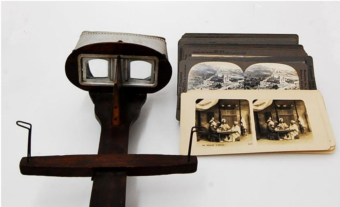
*Figura 13: foto de estereoscópio, de 1904, em madeira e metal, modelo MONARCH, fabricado pela KEYSTONE View Company, com estereogramas ao lado.*
